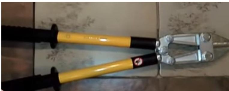
Диэлектрические ножницы для пожарных
